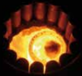
Das Skull-Melting-Verfahren erlaubt tiegfremde Synthesen (ein Teil der Reaktionsprodukte bilden den „Tiegel“) mit Substanzmengen im Bereich von 200 g und bei Temperaturen bis 1750 °C.
