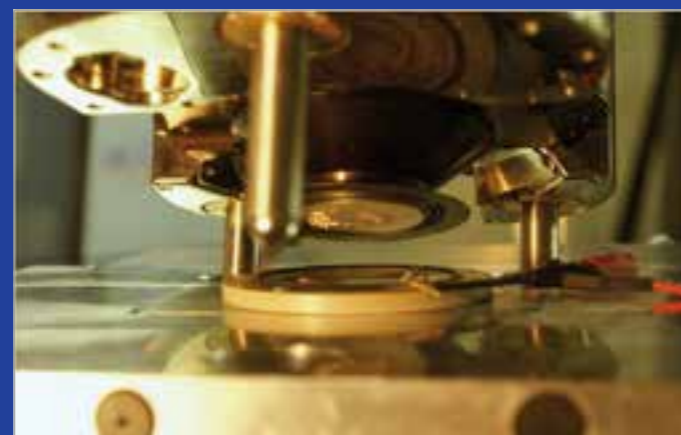
Kombination von Rasterkraftmikroskopie und Elektrochemie zur gezielten Untersuchung von Elektrodeneneigenschaften durch Kraftmessungen
