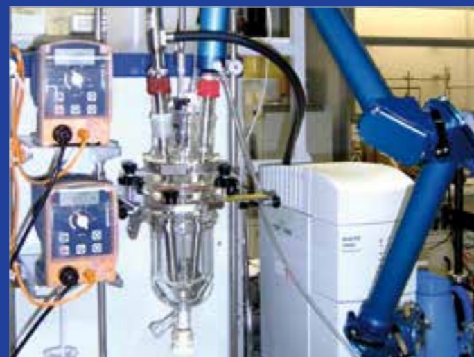
Der automatische Laborreaktor LabMax (Firma Mettler-Toledo) mit IR- und FBRM-Sonde (Partikelgrößen) ermöglicht die Isolation eines metastabilen Polymorphs in mikrokristalliner Form durch gezieltes Induzieren der Keimbildung.
