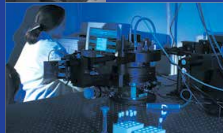
Mit Hilfe der dynamischen Lichtstreuung wird die Größenverteilung von Nanopartikeln bestimmt.
