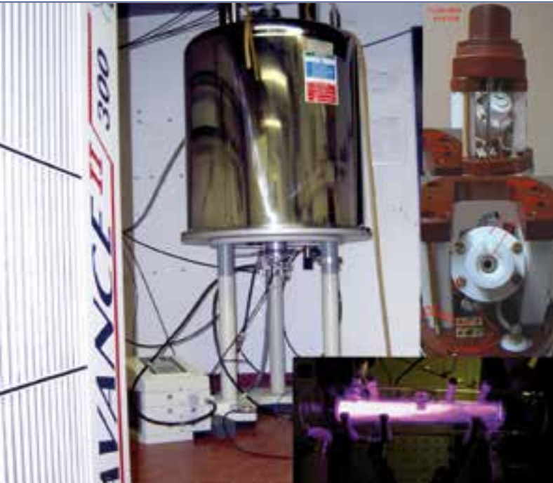
Festkörper-FT-NMR-Spektrometer mit Zubehör für hochauflösende Messungen in kristallinen und amorphen Materialien und Hyperpolarisiertem Xenon für Experimente an Oberflächen
