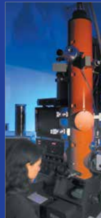
Transmissionselektronenmikroskopie zur Untersuchung von Blockpolymormorphologien
