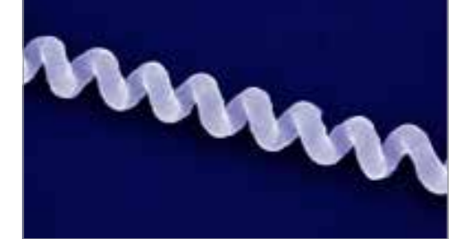
Polymer Nanosprings durch Elektrospinnen mit komplexen Elektrodengeometrien
