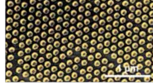
Ein hexagonaler Array hörnchenartiger Gold-Nanopartikel, der durch Partikellithographie hergestellt wurde.
